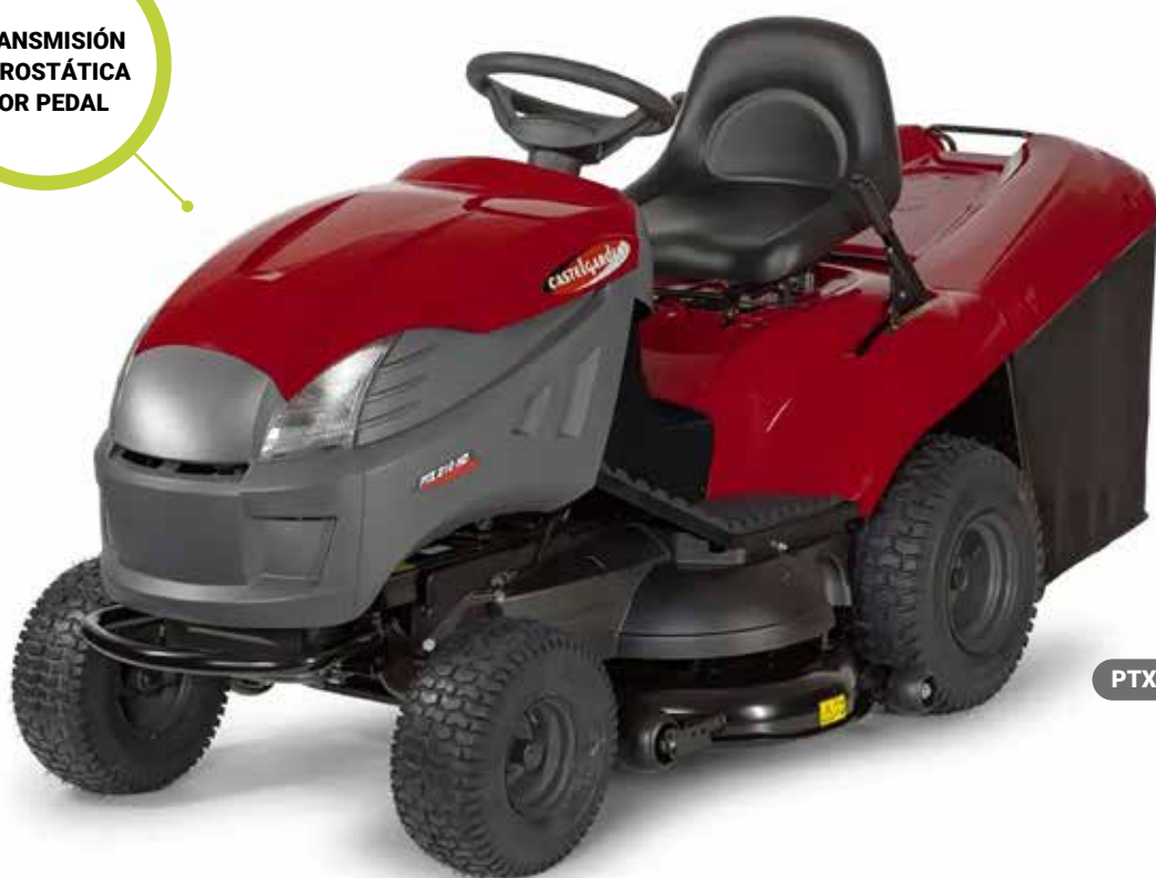
Transmisión hidrostática accionada por pedal
