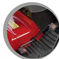
Transmisión hidrostática accionada por pedal
